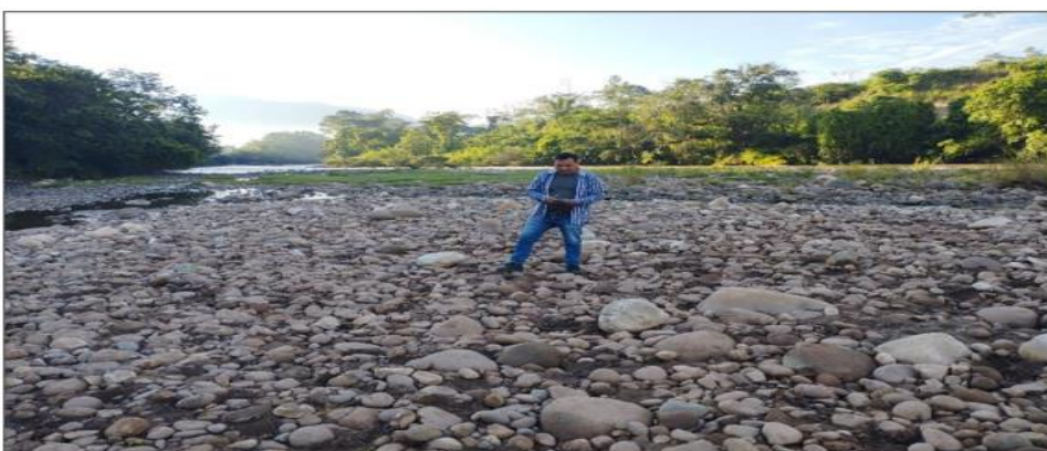
FIGURA N°03: TRAMO DEL CAUCE DEL RIO COLMATADO, DONDE SE APRECIA MATERIAL APROVECHABLE PARA LA CONFORMACION DE DIQUE CON MATERIAL PROPIO.
